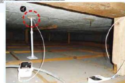
屋内: コンクリート下面温度測定用
