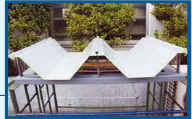
改修前：折板屋根（断熱なし）
