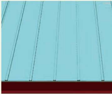
既存瓦棒下地
