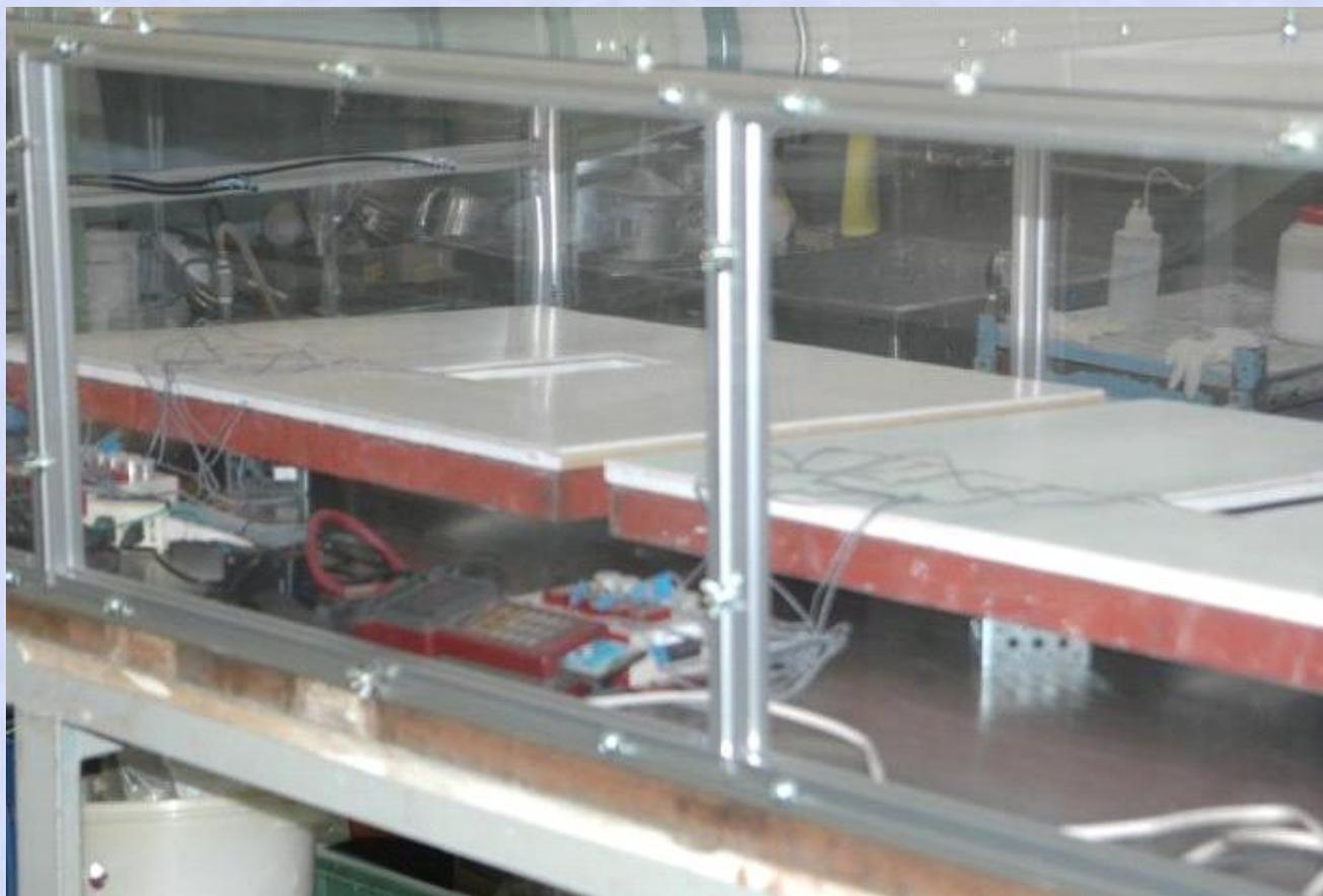
ドライルーム環境は、室温20～25℃、露点温度-30～-40℃:湿度換算1～2%RH等で、この環境を再現する試験装置を作製して、長期暴露による乾燥亀裂の有無と乾燥歪について確認する。
