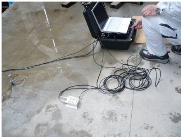
振動測定 スラブ上
