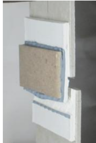
タイル張り用接着剤 /弾性下地調整材:t5
