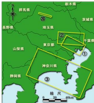
南関東地震断層モデル（この建物の設計で使用した模擬地震動）
