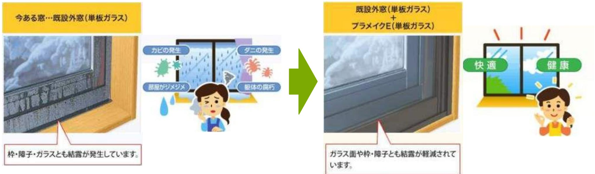
※「プラメイクE」は、室内の暖かい空気を遮断するので、既設外窓の表面温度を下げる場合があります。そのため、室内外の結露を減少させる効果はありますが、既設外窓に結露が発生する場合があります。
