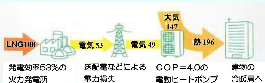
空気の熱を利用するヒートポンプを使えば、同じ燃料を同じ量、投入しても、最終的には燃焼式に比べて2倍の熱エネルギーを取り出すことが可能。
