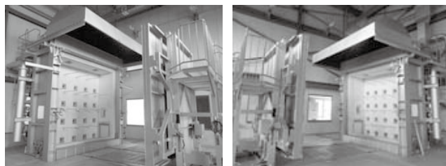
写真1 大型壁炉 (1) 写真2 大型壁炉 (2) (第1期棟内)
