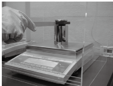
写真-3 校正状況（電子式非自動はかり）
