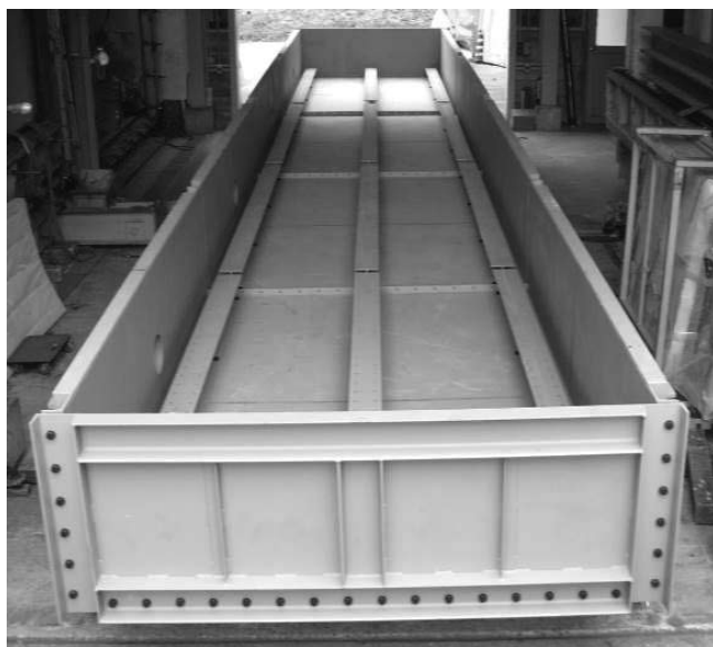
写真1 大型水平圧力装置
