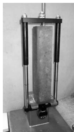
写真-1 コンクリートバーの長さ変化測定状況
