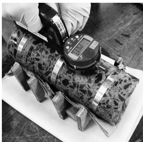
写真-2 コンクリートコアの長さ変化測定状況
