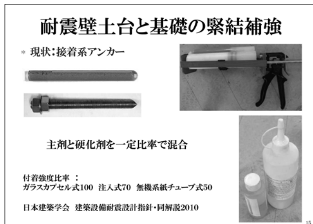
図6 接着系アンカー
