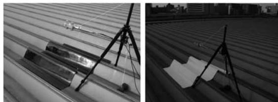
校正板をシートにすることで施工面の形状にあわせて測定可能
