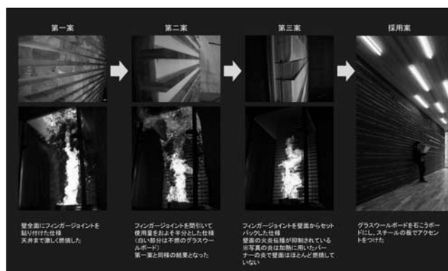
図4 フィンガージョイント吸音材壁の例
