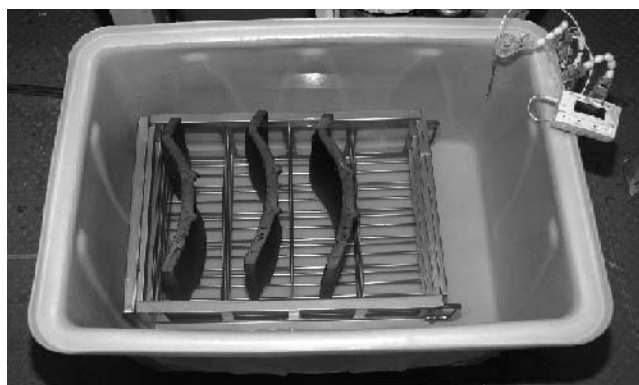
写真-1 吸水試験の浸せき状況
