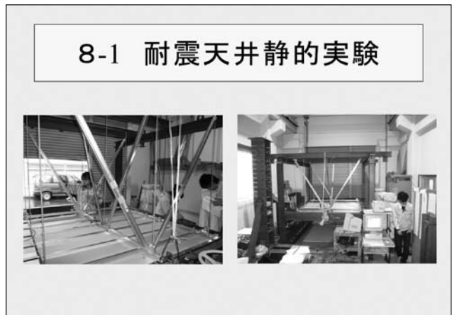
写真2 耐震天井静的実験の様子
