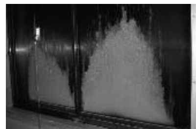
写真-3 結露試験
