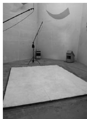
写真-1 残響室吸音率測定法による測定状況
