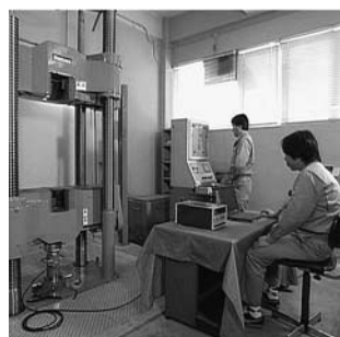
写真-2 一軸試験機の校正状況
