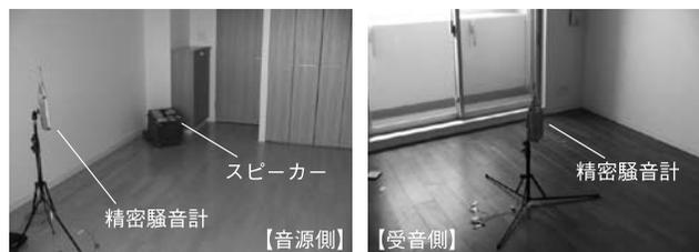
写真-3 室間音圧レベル差の測定状況
