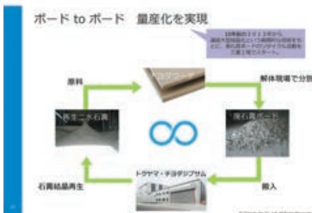
連続大型結晶化技術で廃石膏ボードのリサイクルに取り組む
