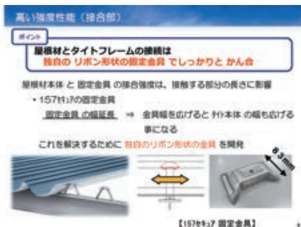
リボン形状の固定金具で接合部強度アップに成功
