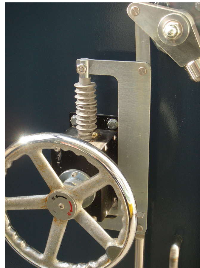
扉締付け回転ハンドル 操作力が軽く強い締付けが可能
