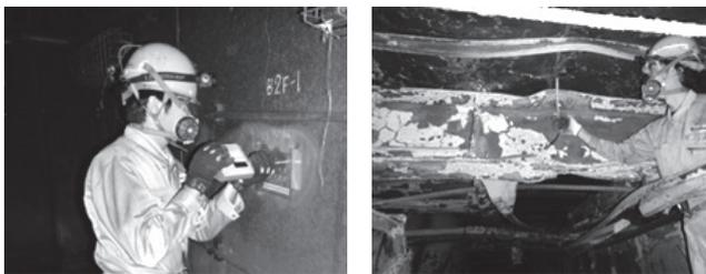
コンクリートの反発度測定
