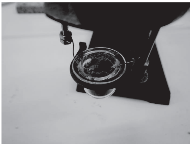
写真-4 試験体の設置状況(フェノールフォーム)
