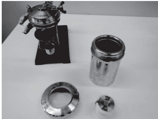
写真-2 試験体燃焼用ボンベ(分解状態)
